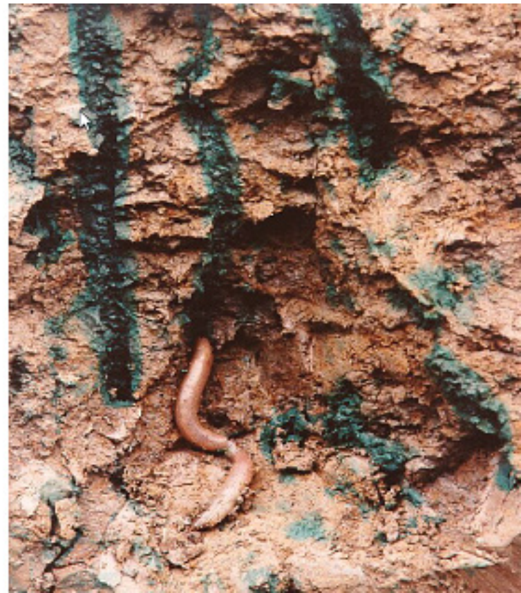
Fig. 7: Modul de curgere a apei în profilul de sol (stânga) și rețeaua de macropori (dreapta) evidențiate prin experiențe de infiltrare cu soluție de contrast
