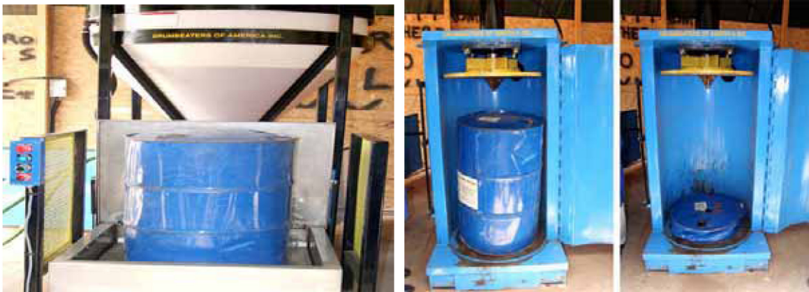
Figura 8: Echipament automat de spălare cu solvent și zdrobire
