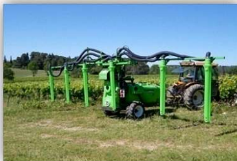
Fig. 19: Mașină de tratamente fitosanitare pe mai multe rânduri
