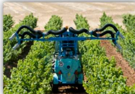
Fig. 19: Mașină de tratamente fitosanitare pe mai multe rânduri
